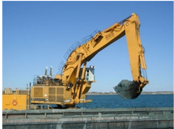
Nordic Giant, en Liebherr 995 og Europas største gavemaskine, går klokkerent med 11.000 liter Panolin HLP Synth i hydrauliksystemet. På billedet er Giant i gang med at uddybe sejlrenden ind til Göteborg.
